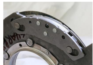
Figure 1: (d) Laminated bifilar pendulum design
